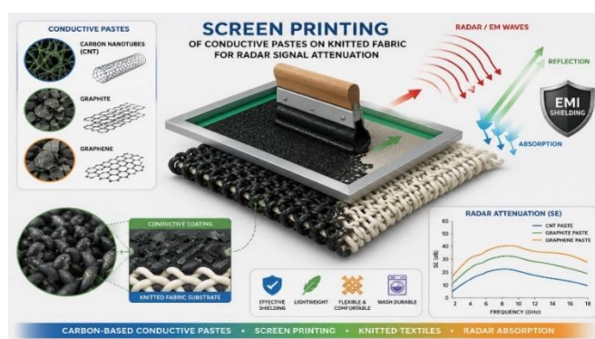
Schemat 1. Lekkie elastyczne materiały ekranujące (EMI), na bazie związków węgla - grafen, grafit, CNT
