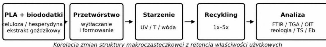
Rysunek 1. Schemat zależności pomiędzy modyfikacją PLA biododatkami, starzeniem, recyklingiem mechanicznym i analizą retencji właściwości
