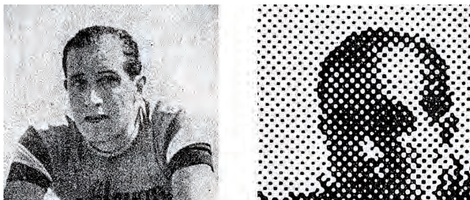
80. Klisza siatkowa i jej powiększony wycinek uwidaczniający siatkę (raster). Dla uzyskania właściwego obrazu należy popatrzeć na wycinek z odległości 2-3 kroków
