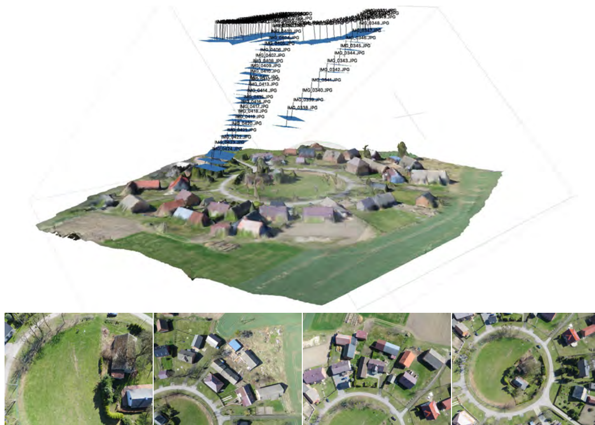
Rycina 9: Budowa modelu 3D obszaru wsi Czerwona (niebieskie prostokąty wskazują lokalizację wykonanych fotografii względem modelu; poniżej modelu zamieszczono przykładowe fotografie wykorzystane do jego budowy)
