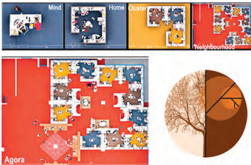
Rysunek 2. Projekt biura wykorzystujący założenia architektury fraktalnej (plan węższy)
