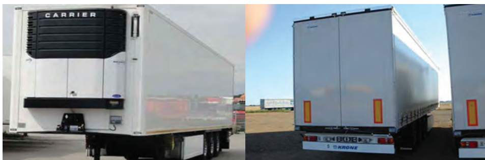
Ilustracja 6. Naczepa typu chłodnia – załadunek możliwy tylko tyłem oraz naczepa typu firanka (wymiar 13,6 m x 2,5 m x 2,7 m)
