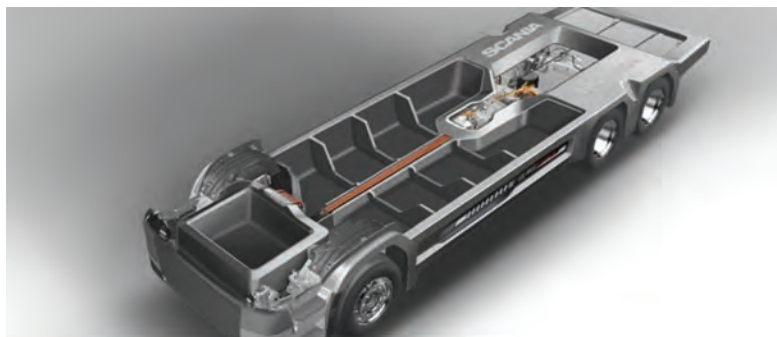
Ilustracja 43. Rama kompozytowa pojazdu Scania
