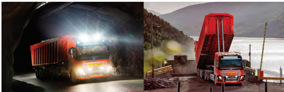
Ilustracja 47. Samobieżne ciężarówki Volvo przejeżdżają przez 5 km tuneli i wyładują wapień do kruszarki w pobliskim porcie
