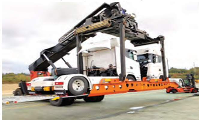
Bimodalny: specjalna naczepa siodłowa jako „wagon” z wymiennymi wózkami jezdnyymi
