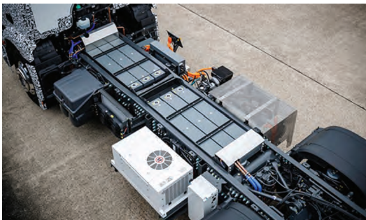
Ilustracja 27. Układ napędowy eActros
