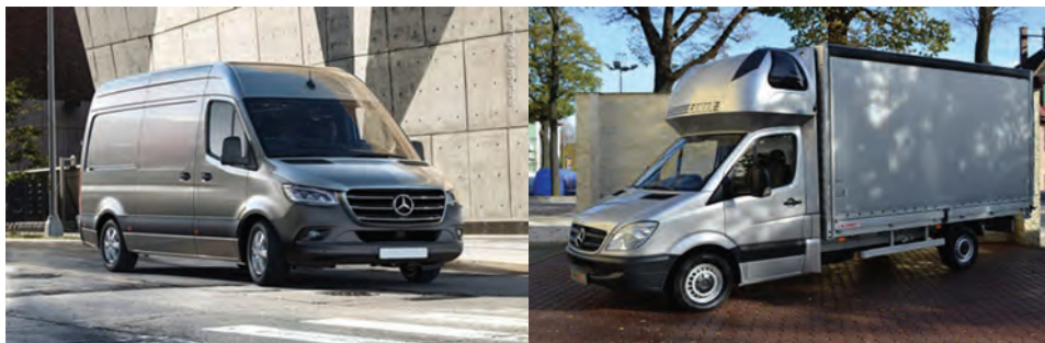
Ilustracja 3. Pojazd ciężarowy o nadwoziu uniwersalnym – typ zabudowa sztywna, furgon oraz pojazd ciężarowy o nadwoziu uniwersalnym – typ skrzynia
