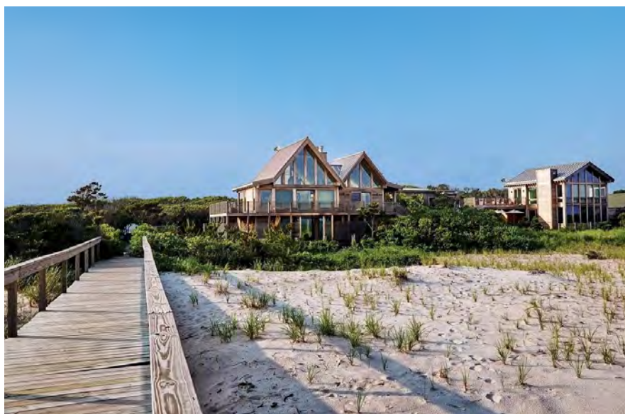
Ryc. 4.11. Domy wzniesione na wydmach – w celu stabilizacji piasków powierzchnie wydym obsadzone są trawami, wybudowano także drewniane ścieżki
