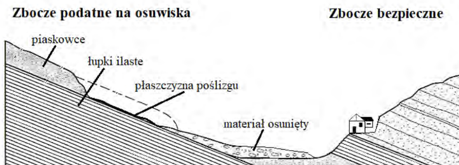
Ryc. 7.11. Wpływ ułożenia warstw skalnych na niebezpieczeństwo wystąpienia osuwiska
