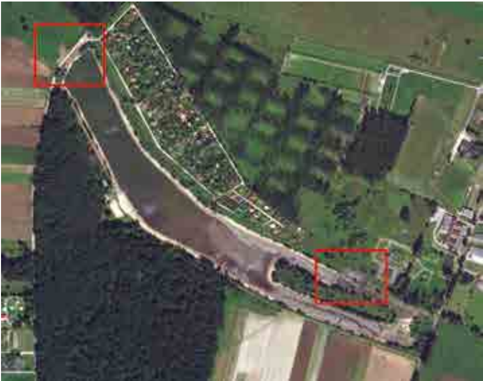
Fot. 2.32. Zalew w Leżnicy Wielkiej – wskazano miejsca uszkodzeń po powodzi w 2010 roku
