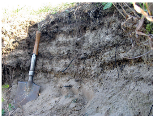
Ryc. 62. Osady powodziowe pozakorytowe złożone z naprzemiennie ułożonych warstw piaszczystych i mulkowych zawierające detrytus roślinny w środkowym odcinku doliny Bzury
