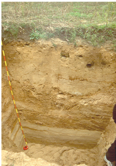
Ryc. 81. Budowa geologiczna terasy nadzalewowej, przykład doliny Rawki w Kamionie
