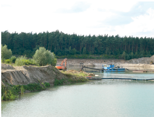
Ryc. 38. Eksploatacja piasków i żwirów sandrowych spod lustra wody przy pomocy pogłębiarki w okolicach Strykowa
